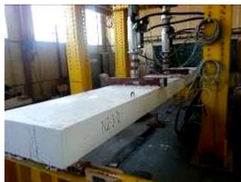
Experimentálna skúška nosníka
