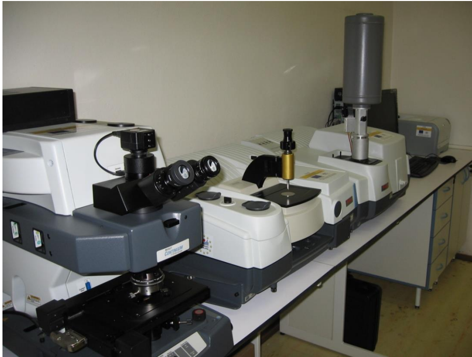
Obr. 3 Systém na meranie vibračných spektier
